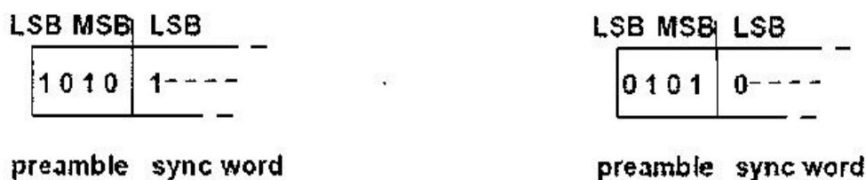
شکل ۲-۷: دنباله در CAC وقتی MSB در کلمه همزمانی صفر (الف) و یا یک (ب) است
