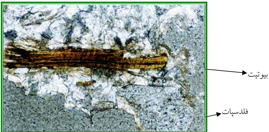
شکل ۱۰- تصویر مقطع نازک تهیه شده از فراکسیون ( $40\times$ ) میکرون (۴۰۰، ۳۳۶۰+) میکرون
