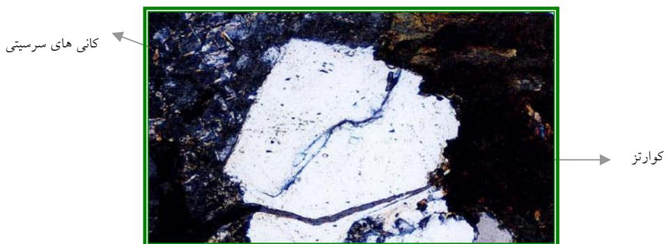
شکل ۵ - تصویر مقطع نازک تهیه شده از فراکسیون ( $+3360$ ،  $-4760$ ) میکرون (۴۰X)
